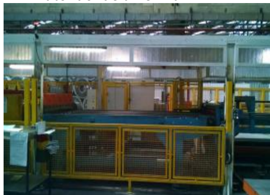
Figura 8 - Guilhotina de Corte e Esteira de Transporte / Conferência de blanks atendendo à norma NR-12.
