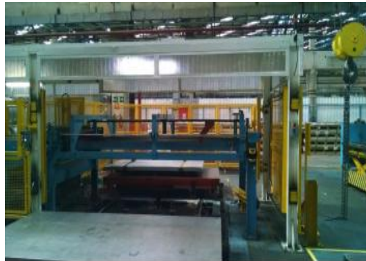
Figura 12 - Saída de blanks atendendo à norma NR-12
