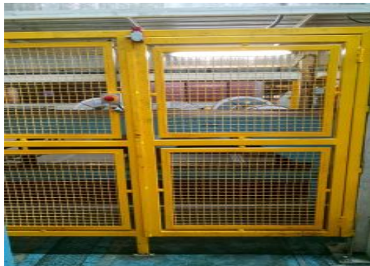
Figura 9 - Guilhotina de Corte e Esteira de Transporte / Conferência de blanks atendendo à norma NR-12
