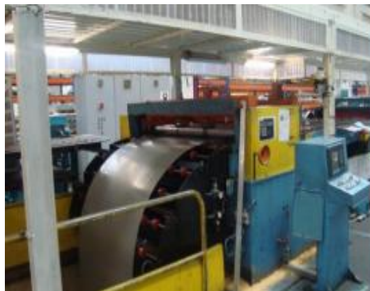
Figura 5 - Poço auxiliar para desbobinamento
